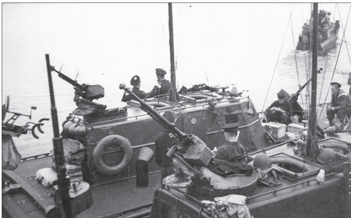
Doskonały przykład ilustrujący nieetatowość montowanego na poszczególnych kutrach uzbrojenia strzeleckiego. Na fotografii widoczny okręt uzbrojony w wkm DSzK umieszczony na nadbudówce i dziobie oraz działko 20 mm Oerlikon na postumencie w części rufowej.
