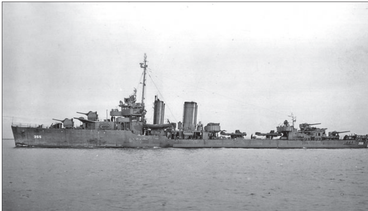
Zmodernizowany niszczyciel Aylwin na fotografii z 3 stycznia 1943 roku po opuszczeniu Mare Island Navy Yard. Na maszcie dziobowym widoczny radar typu SG.
