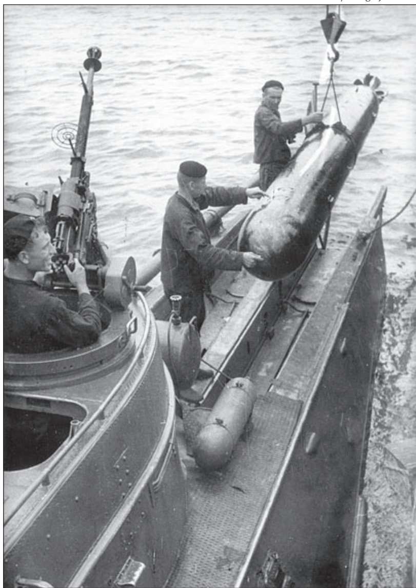
Łaładunek torpedy, z lewej strony widoczne stanowisko wkm-u DSzK kal. 12,7 mm.
