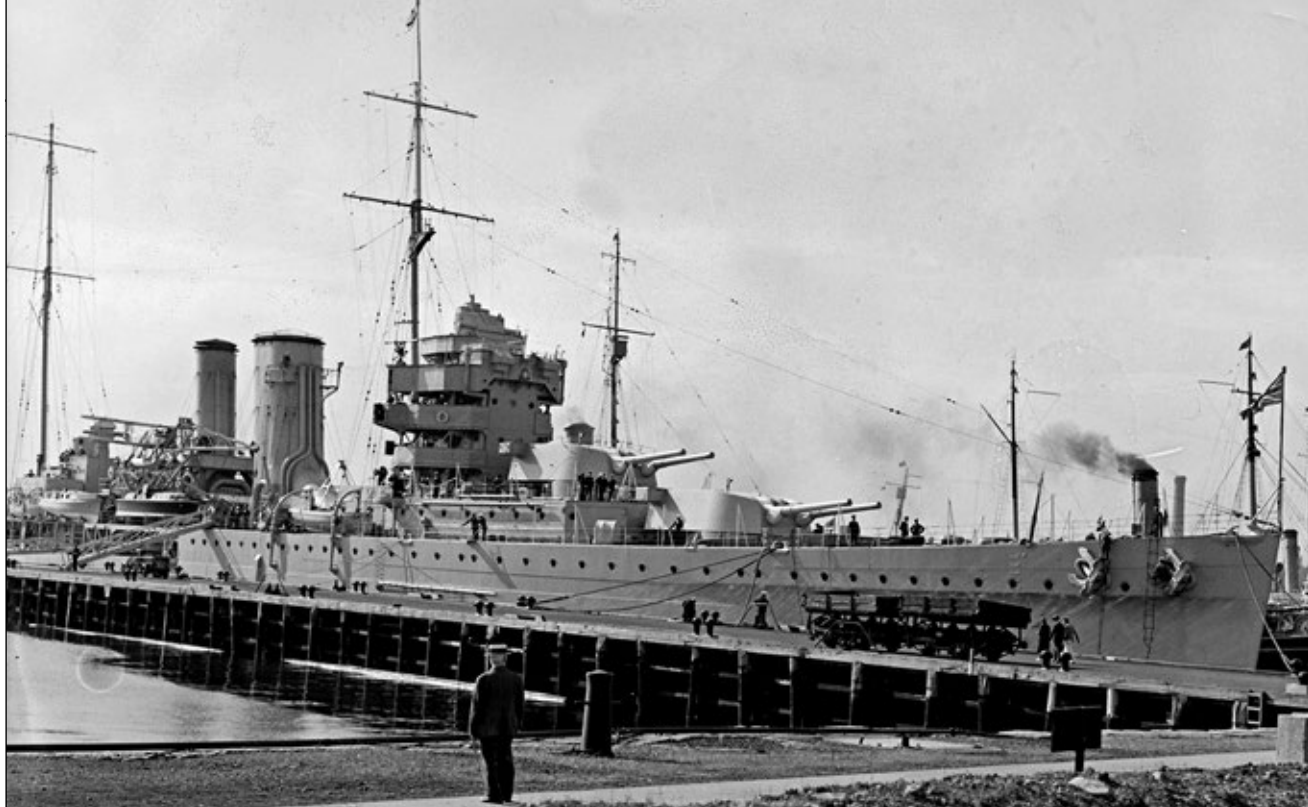
York w latach 30-tych. Dobrze widoczne dziobowe wieże artylerii głównej kal. 203 mm.
