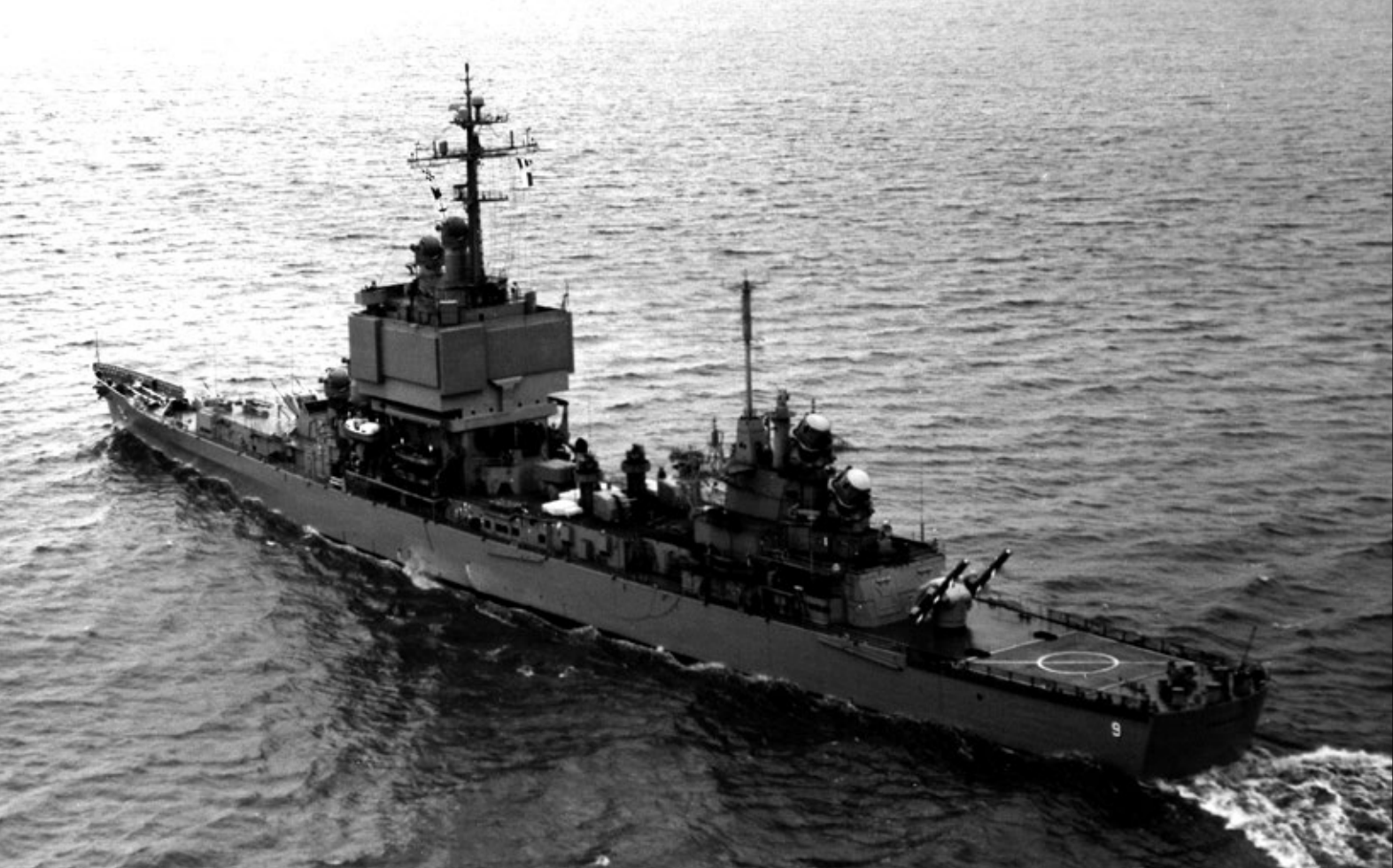
Ujęcie Long Beach od rufy z doskonale widocznym zestawem uzbrojenia i wyposażenia w tej części okrętu: dwuprowadnicową wyrzutnią pocisków rakietowych RIM-8 „Talos”, a ponad nią radarami kierowania SPG-49/SPW-2. Za nadbudówką rufową dwie wieże dział uniwersalnych kalibru 127 mm L/38, za którymi widoczne są dalocelowniki Mk 56, a dalej wyrzutnia pocisków przeciwpodwodnych ASROC.
