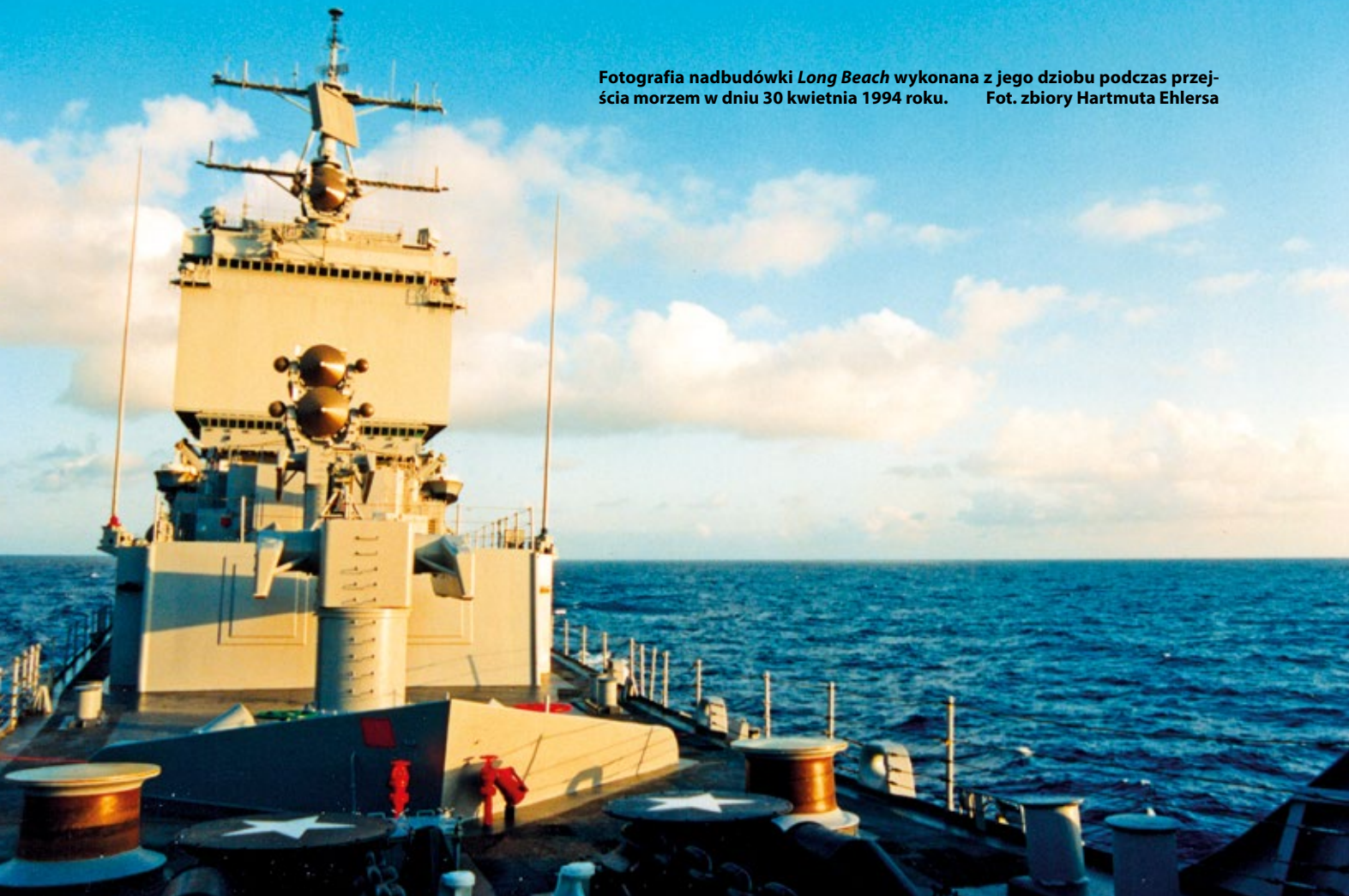
Wyrzutnia nr 2 przeciwniczych rakietowych pocisków kierowanych RIM-67B „Standard” SM-2ER. Za nią widoczne stacje radiolokacyjne ich naprowadzania SPG-55. Fot. zbiory Hartmuta Ehlersa
