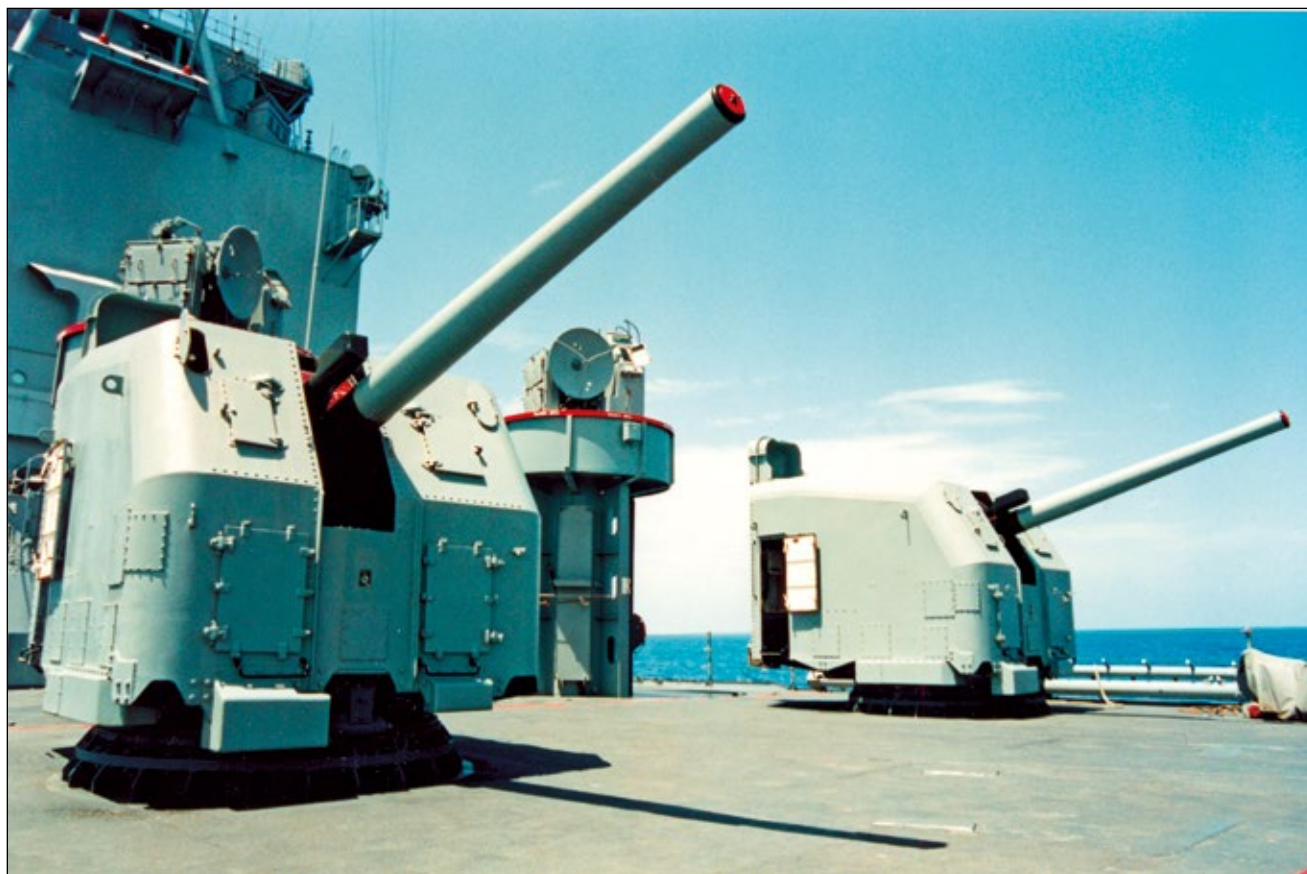
Działa artylerii uniwersalnej kalibru 127 mm L/38 w pojedynczych wieżach Mk 30 stanowiły podstawę artylerii lufowej Long Beach .
