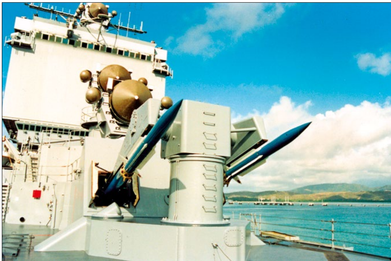
Wyrzutnia nr 2 przeciwniczych rakietowych pocisków kierowanych RIM-67B „Standard” SM-2ER. Za nią widoczne stacje radiolokacyjne ich naprowadzania SPG-55. Fot. zbiory Hartmuta Ehlersa
