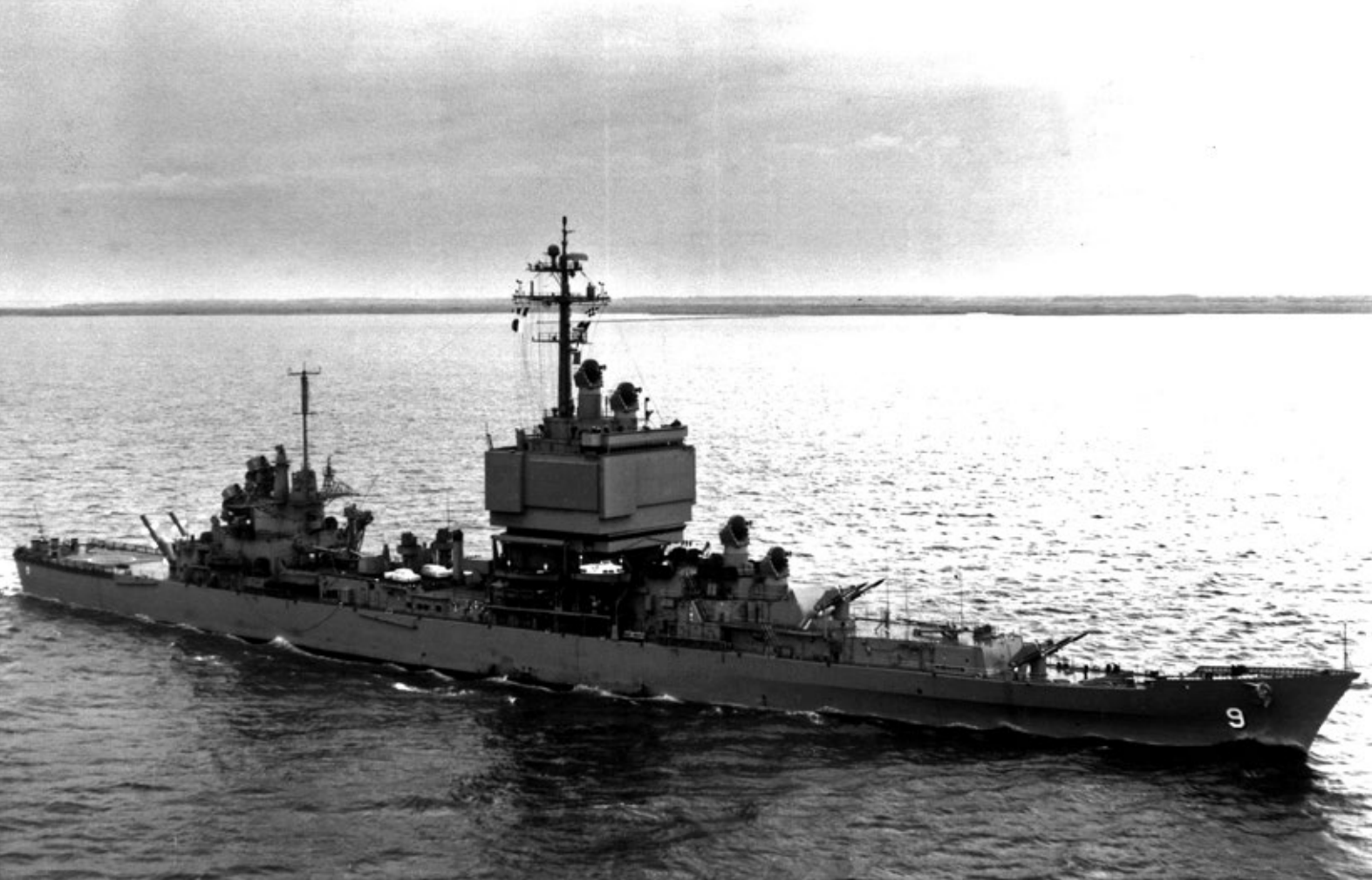
Long Beach w ujęciu od dziobu. Zestaw jego uzbrojenia i wyposażenia w tej części stanowiły dwie dwuprowadnicowe wyrzutnie pocisków rakietowych RIM-2 „Terrier”, ponad którymi widoczne radary ich kierowania SPG-55. Na nadbudówce usytuowane prostokątne anteny radiolokacyjnych zestawów matrycowo-fazowanych SPS-32/SPS-33. Fot. zbiory Arthura D. Bakera III
