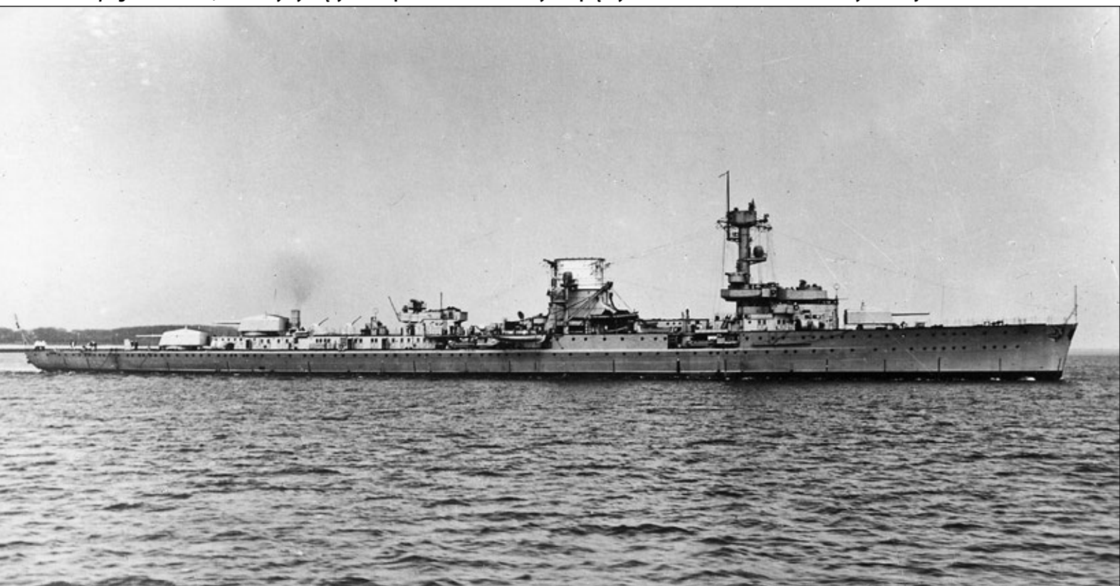
Leipzig w 1931 roku, widoczny dymiący komin przedziału silników wysokoprężnych.
