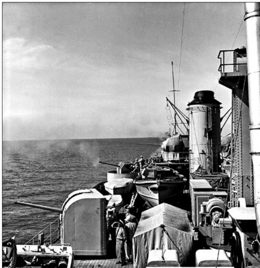
Jeanned'Arc w 1955 roku. Na pierwszym planie widoczne działko kal. 75 mm z maską ochronną, za nim Bofors kal. 40 mm.
