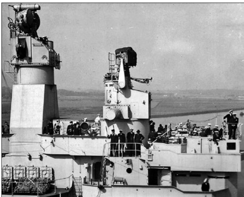
Dąłocelowniki z radarami nad pomostem Vanguarda , rzut boczny.
