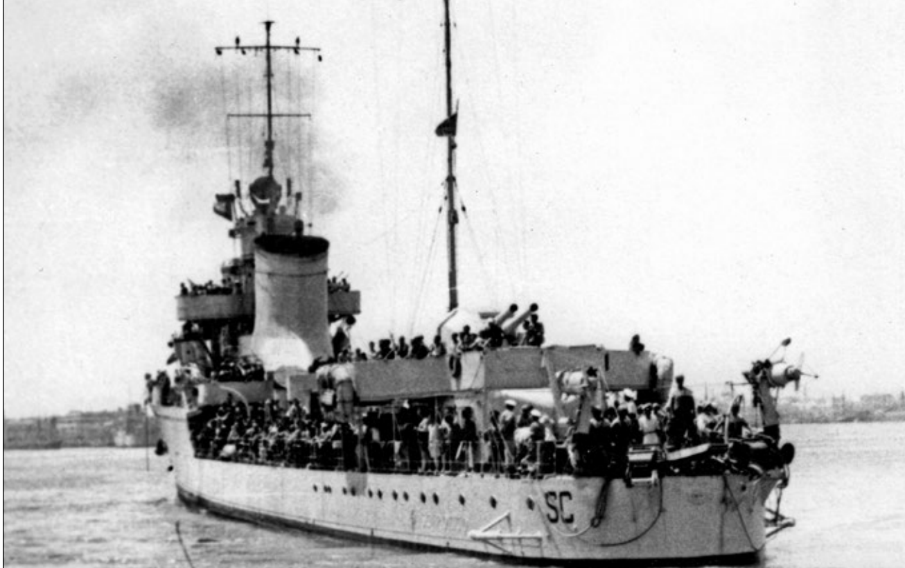
Scirocco w latach 1940-41. Dobrze widoczne na rufie parawany przeciwmìnowe i zrzutnie bomb głębinowych.
